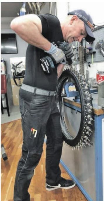
Knifflig: Innerhalb von drei Tagen wurden die Reifen der Husqvarna mit Spikes ausgerüstet.
